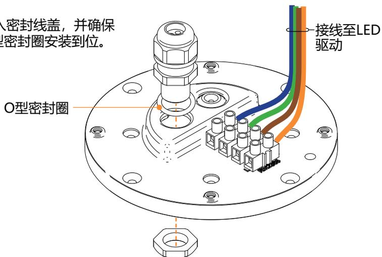
将线缆穿过密封线盖并拧紧，线缆外径范围Ø5-10mm
